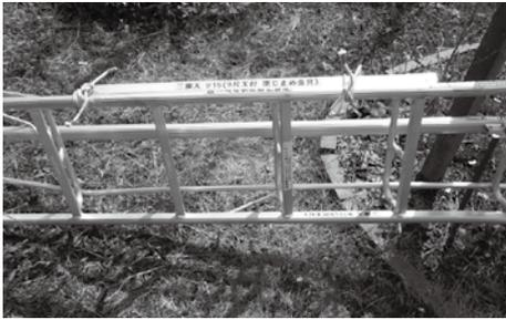
「閉じ止め金具」を三脚脚立とセットにして装備している (武蔵野市シルバー人材センター)
